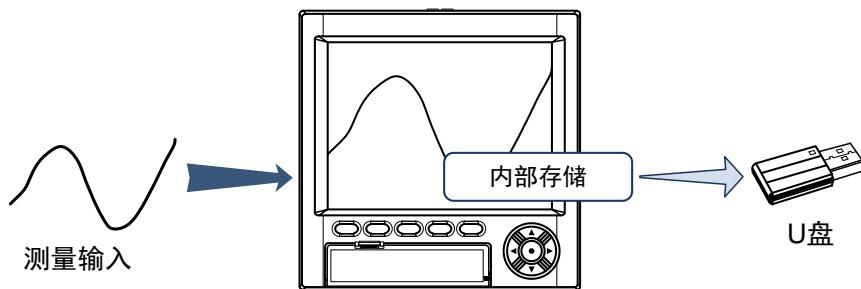
本记录仪将以前记录在记录纸上的测量/运算数据显示在液晶屏上，显示数据中的曲线画面相当于走纸记录仪在记录纸上绘制的曲线。测量/运算数据同时保存在内存中，也可以在插入外部存储设备时通过手动备份的方式保存在外部存储媒体中。
