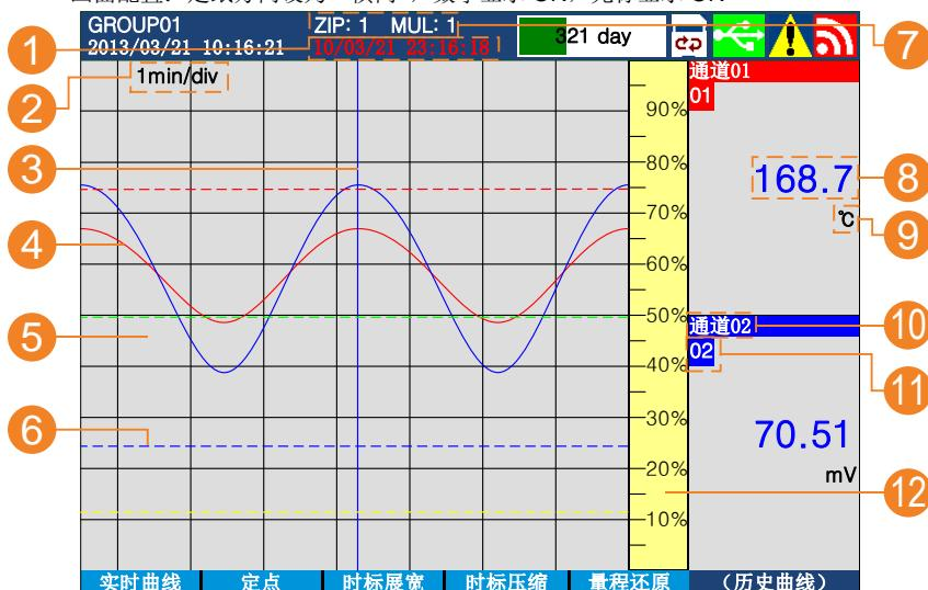
历史曲线画面的画面配置方式与实时曲线画面一致。同样可以设置横竖两种走纸方式，以及设置数字显示 ON/OFF。
